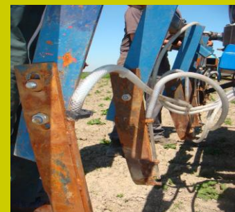
Het is een eenvoudig systeem dat werkt met slangenpompjes
