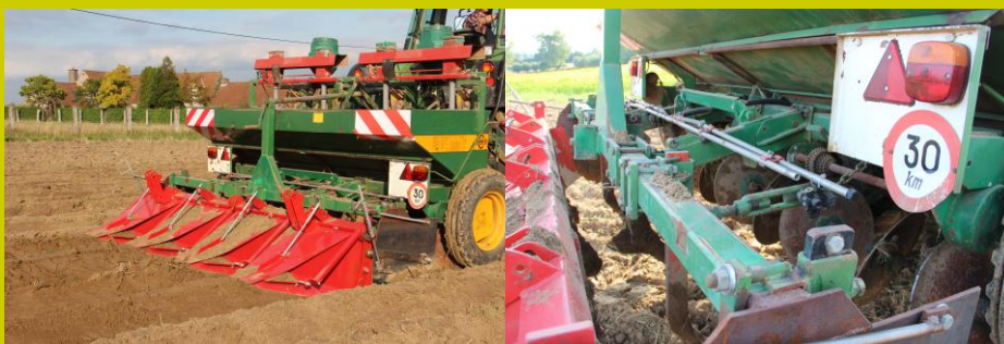
De Cramer pootmachine uit 1993 werd uitgebreid met nieuwe roestvrijstalen rugvormkappen.
